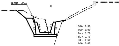
流路工 掘削・埋戻し・斜面整地 計算表
